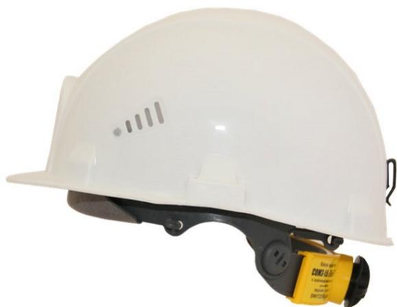
Каска состоит из ударопрочного корпуса, выполненного из материала TermotreK®, внутренней оснастки TreK®, плавной регулировкой RAPID и подбородочного текстильного ремня. Внутренняя оснастка TreK® включает в себя ленты из смеси материалов Nanotrek® Germany, амортизатор с подвесками из полиэтилена. Корпус каски с вентиляционными отверстиями, пазами для крепления наушников противозумных и/или щитков защитных лицевых и водосточным желобком имеет суперлегкий вес, создает высокий уровень комфорта
